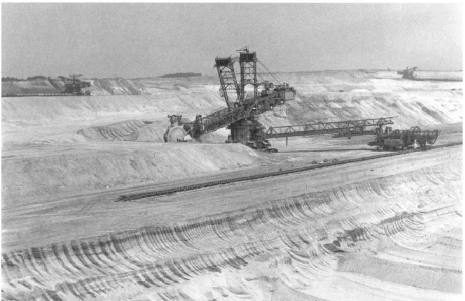
23. Desgl., Schaufelradbagger im Einsatz, ca. 1963.
