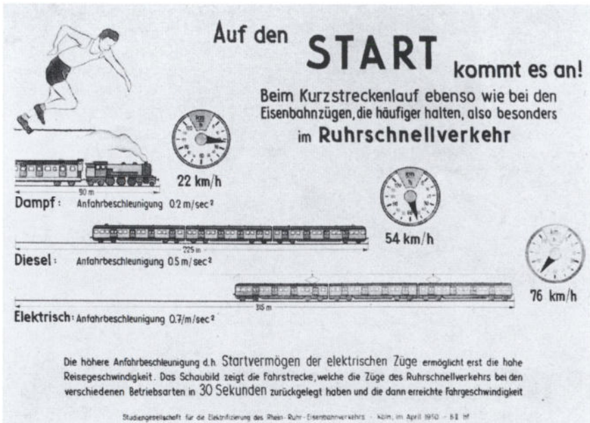
Abb. 12: Veranschaulichung des Anzugsvermögens von Dampf-, Diesel- und elektrischen Zügen.
